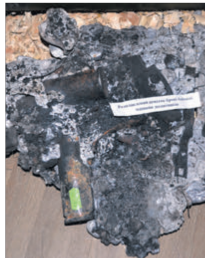
Від високої температури гільзи вплавилися в обшивку бронетехніки.
