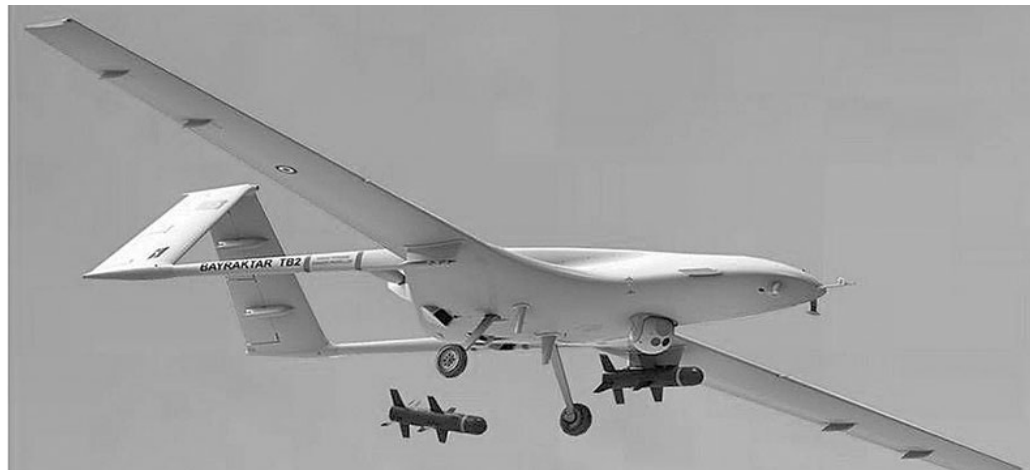
Bayraktar TB2 має довжину 6,50 м, розмах крил 12 м. Розвиваючи максимальну швидкість близько 220 км/год, може перебувати в повітрі добу.
