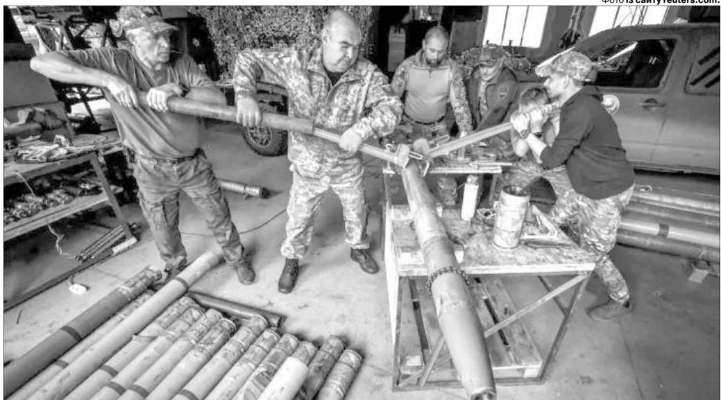
Члени ротної тактичної групи «Степові вовки» Добровільного формування Запорізької територіальної громади розбирають снаряд для РСЗО БМ-21 «Град», щоб переобладнати його для використання з саморобною малогабаритною РСЗВ.
